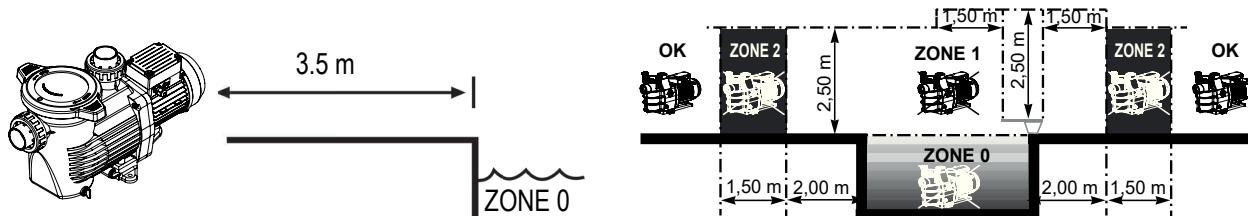
Installera pumpen i ett torrt utrymme med god ventilation. Motorn kräver att luften får cirkulera fritt runt den för naturlig ventilation. Kontrollera regelbundet att inga föremål, löv eller skräp blockerar motorns kyldrager. Installera pumpen så att den yttre strömbrytaren på de fasta ledningarna är väl synlig och är lätt åtkomlig. Strömbrytaren måste sitta nära pumpen.
