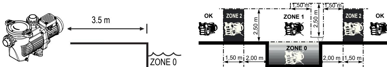
De pomp in een verluchte en droge ruimte installeren, de lucht moet vrijelijk rond de motor kunnen circuleren zodat hij op natuurlijke wijze verlucht kan worden. Regelmatig controleren of de motorkoeling niet verhinderd wordt door voorwerpen, bladeren of andere obstakels.
