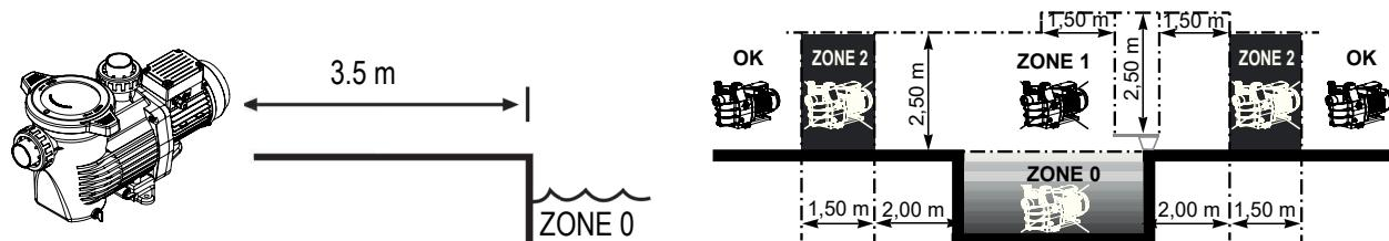
Installare la pompa in un locale ventilato e asciutto, poiché il motore richiede che l'aria circoli liberamente attorno ad essa, per consentirne la ventilazione naturale. Verificare regolarmente che il dispositivo di raffreddamento del motore non sia ostruito da oggetti, foglie o altri ingombri.
