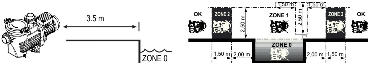
Установите насос в проветриваемом сухом месте. Для естественной вентиляции двигателя необходимо обеспечить свободную циркуляцию воздуха вокруг него. Необходимо периодически проверять, что охлаждению двигателя не препятствуют какие-либо объекты, листья и прочие предметы.
