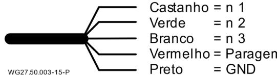
Os cabos têm de ser ligados sem potencial. Ligue os contactos apenas individualmente (respeite a sua prioridade), caso contrário a velocidade de rotação pretendida não é ativada. Para o comando externo, é necessário ativar as entradas digitais correspondentes no menu de configuração.
